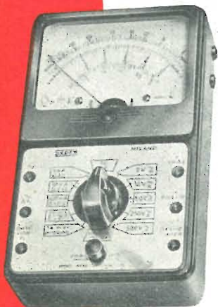
Analizzatore megaohmmetro capacimetro mod. 609 - 20.000 \Omega/V
